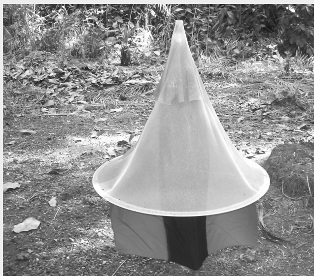
Рис. 3. Коническая ловушка для отлова мух цеце, импрегнированная пестицидом
