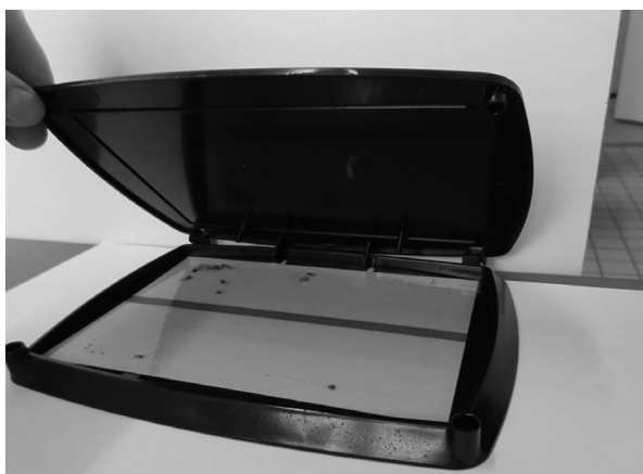
Рис. 1. Инсект-монитор с клеевым вкладышем
