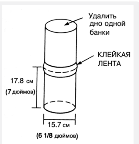
Рис. 1. Простой способ изготовления ловчих цилиндров (по Хейер и др., 2003)
