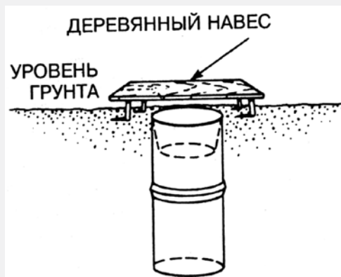
Рис. 3. Защитная крышка на ловчем цилиндре (по Хейер и др., 2003)
